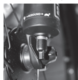
REGULACJA TŁUMIENIA AMORTYZATORA
