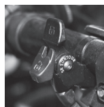
DŹWIGNIA BLOKADY SKOKU MONTOWANA NA KIEROWNICY
